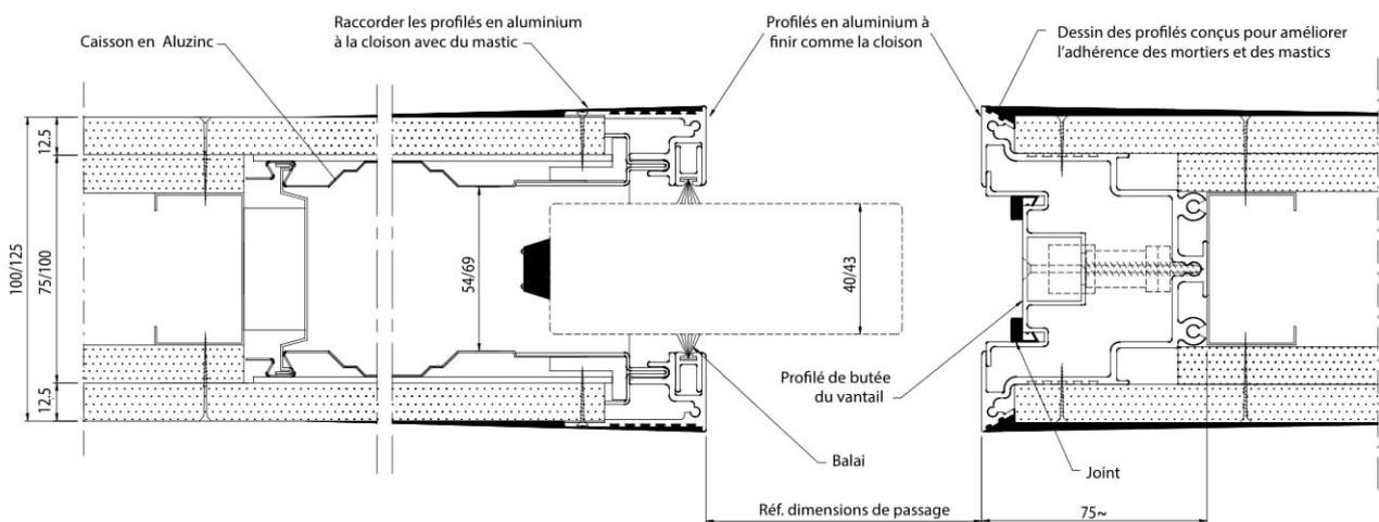
\* Pour les cloisons de 100 mm, l'épaisseur maximale de la porte est de 40 mm
