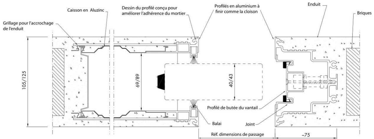
Contre-châssis pour porte coulissante escamotable sans kit de finition pour cloison en plaques de plâtre de 100 mm et de 125 mm
