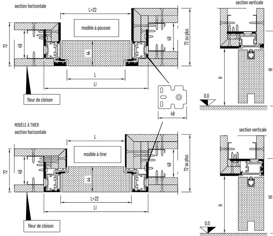
**MONTAGE DANS LES CLOISONS EN BRIQUE**
